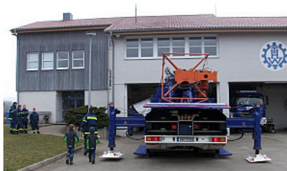
Innerhalb einer halben Stunde war der Mastkraftwagen auf dem Gelände des THW Ortsverbandes Hechingen aufgebaut worden. Auf der Mastanlage wurde hierzu eine Kombinationsantenne 2m/4m und die Dome Kamera installiert.
