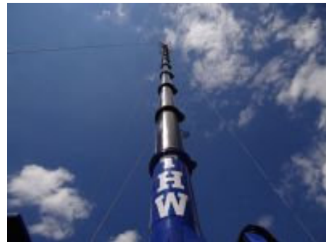
MastKW auf 40 m ausgefahren
