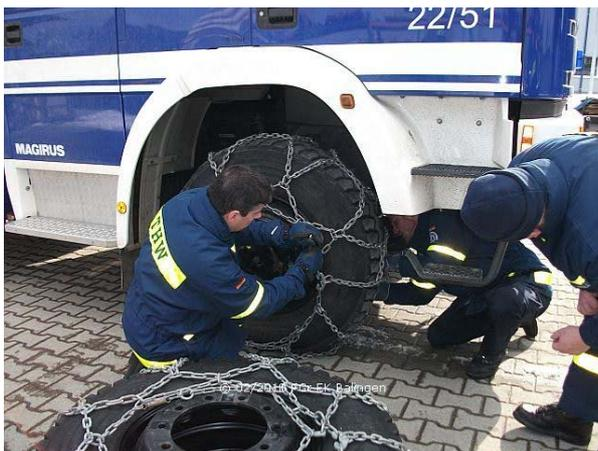
Im praktischen Teil der Ausbildung lernten und übten die Kraftfahreranwälter auf dem Übungsgelände des THW OV Horb das korrekte Ankuppeln eines Anhängers und das fehlerfreie Auflegen von Gleitschutzketten.
